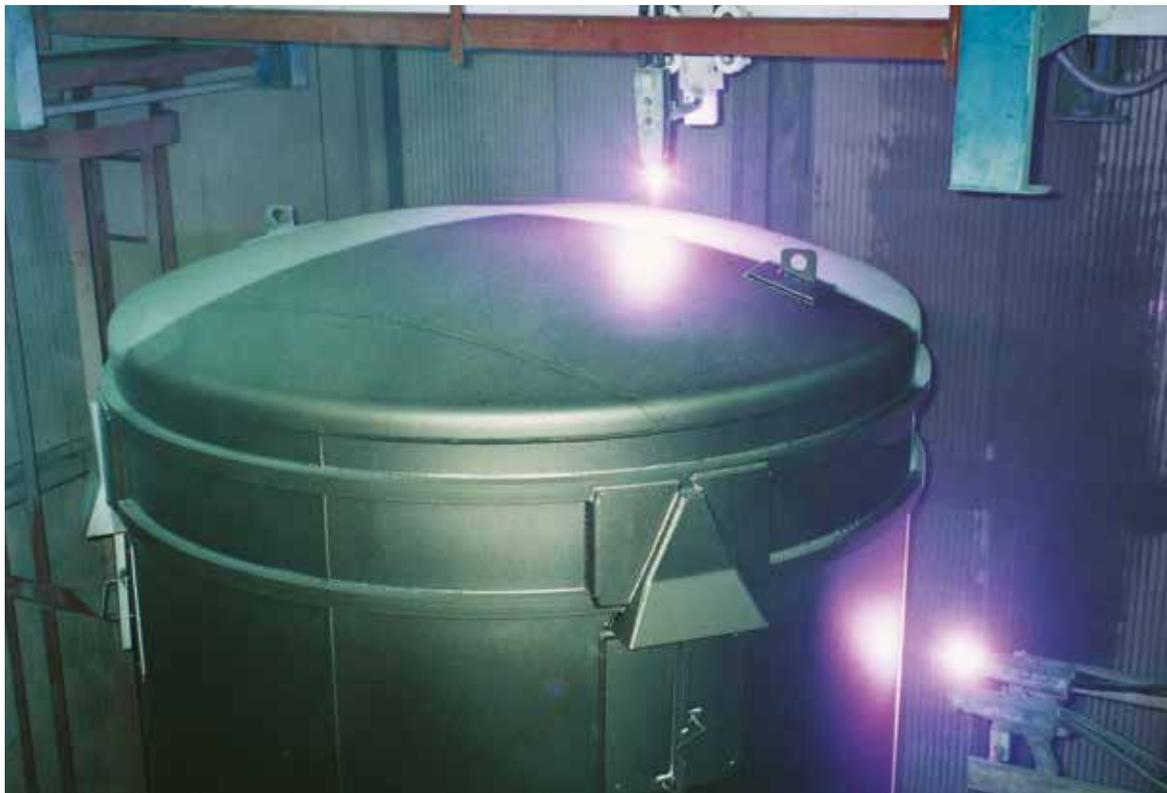
Автоматическая окрасочная и дробеструйная установка для силосов.
