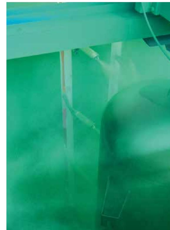
Автоматическая установка порошковой покраски с эпоксидным порошком. Толщина слоя краски на изделиях 500 микрон.
