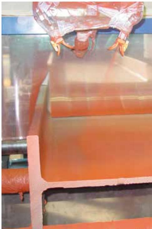
Фаза автоматической покраски выполняется двумя противоположными роботизированными руками, на которых установлены распылители.
