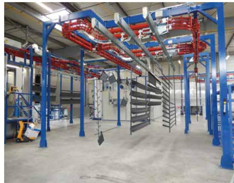
Автоматическая система предварительной обработки и порошковой покраски для алюминиевых профилей с сертификацией QUALICOAT в комплекте с горелками прямого обмена с вентиляцией.
