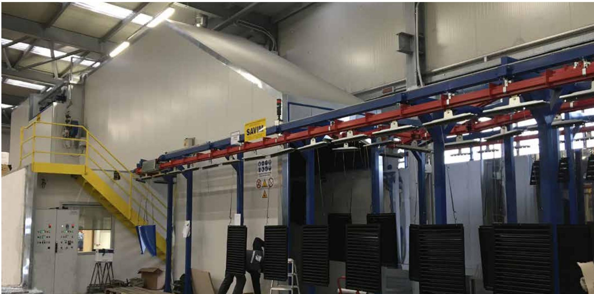
Автоматическая система предварительной обработки и порошковой покраски с колпаковой печью в комплекте с горелками прямого обмена с вентиляцией.
