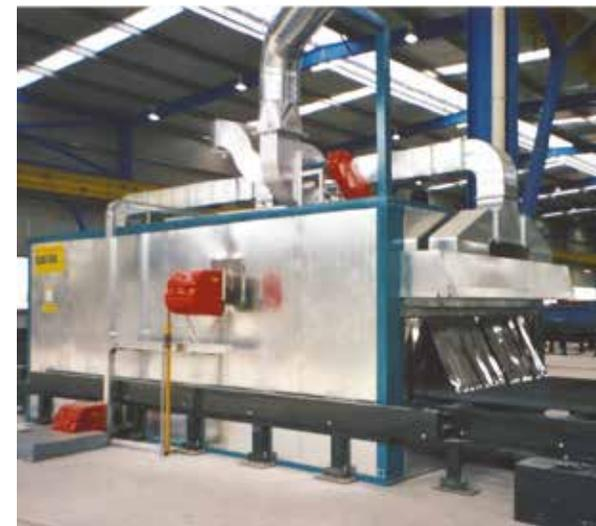
Печь предварительного нагрева 300°C, установленная в начале линии, оптимизирует дальнейшую очистку деталей и способствует применению красок на водной основе.
