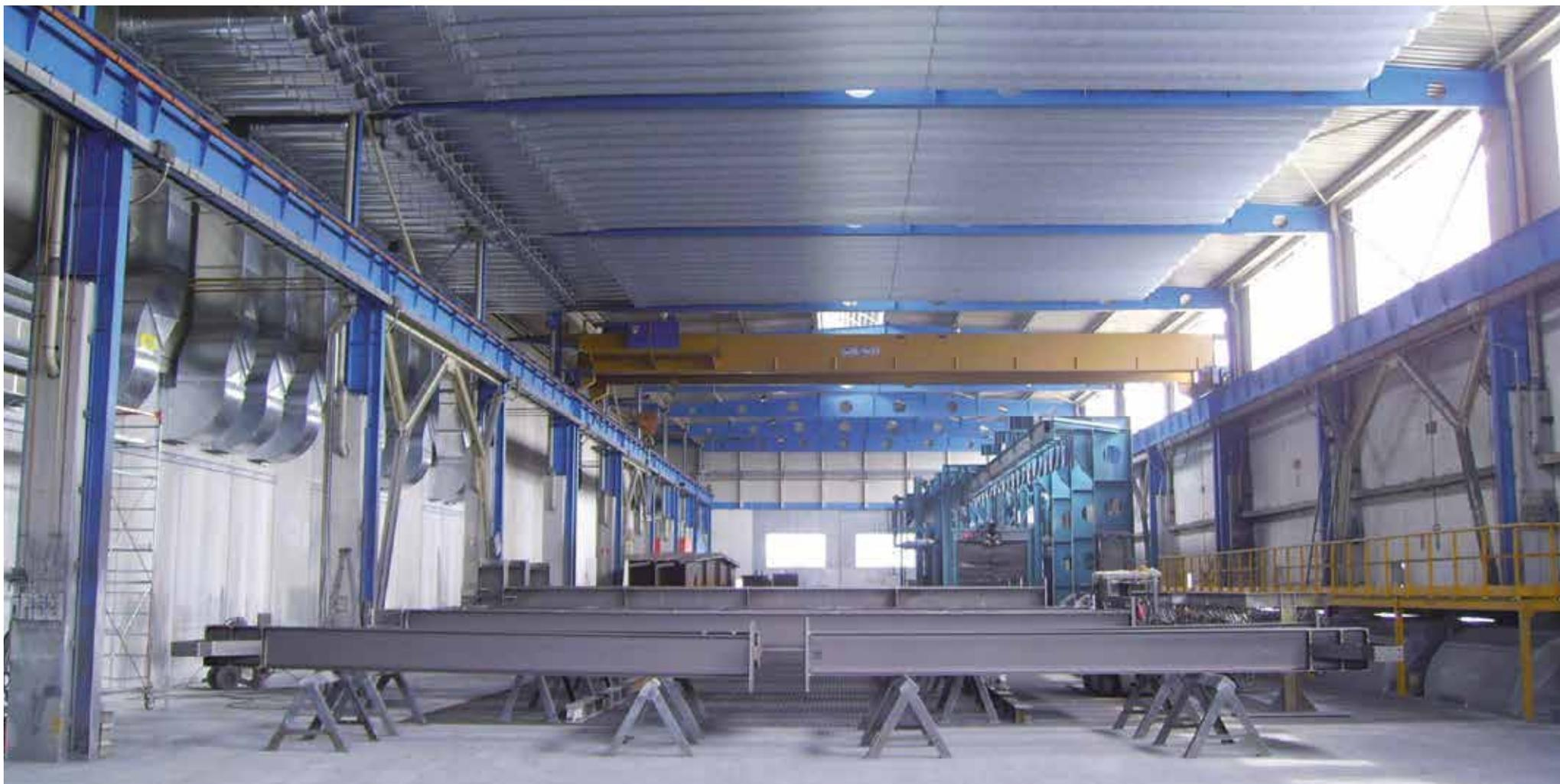
Покрасочные решетчатые поверхности для металлоконструкций. Распространение воздуха внутри рабочего пространства происходит через специальные микро- перфорированные трубы диффузора.
