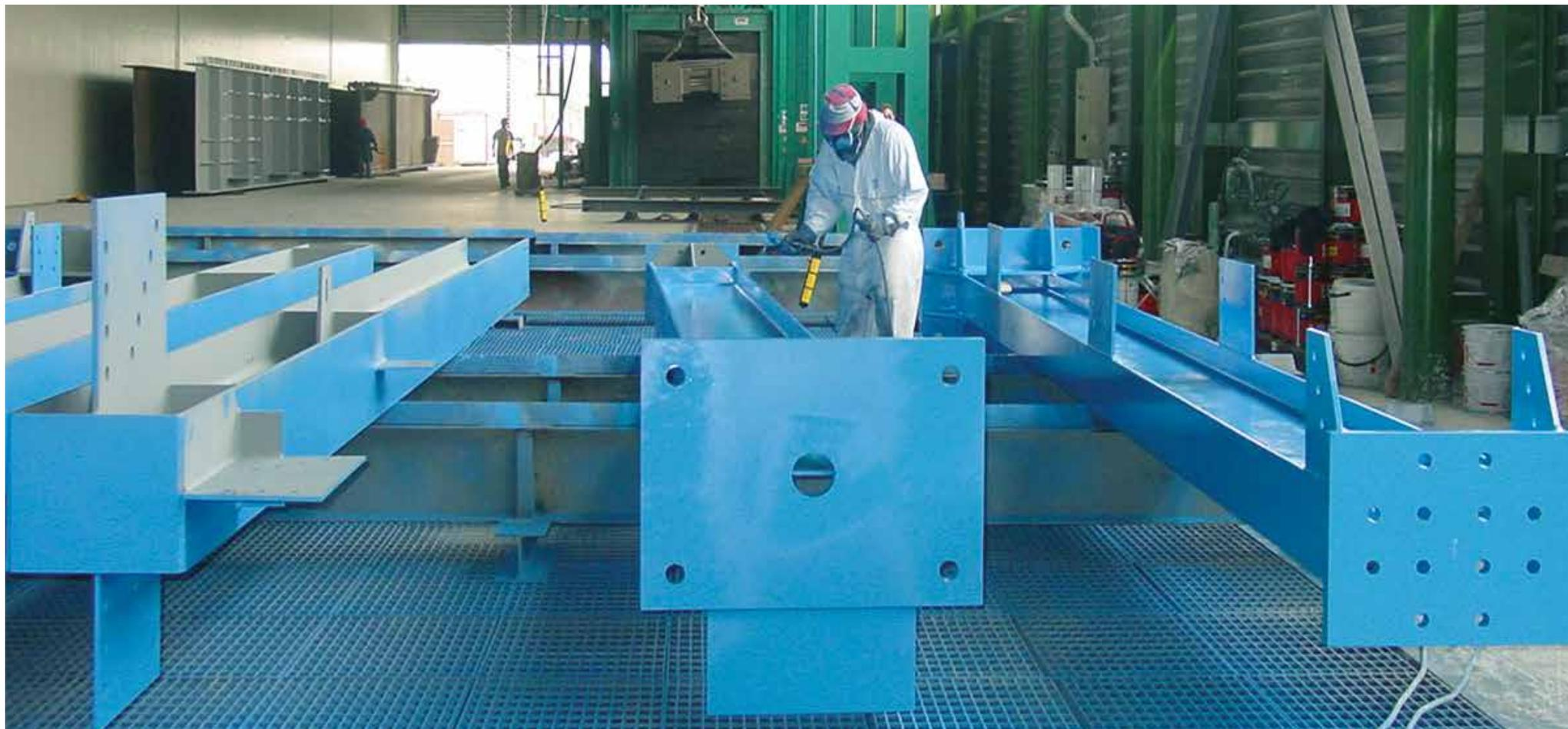
Покрасочная решетчатая поверхность с системой сухой фильтрации.
