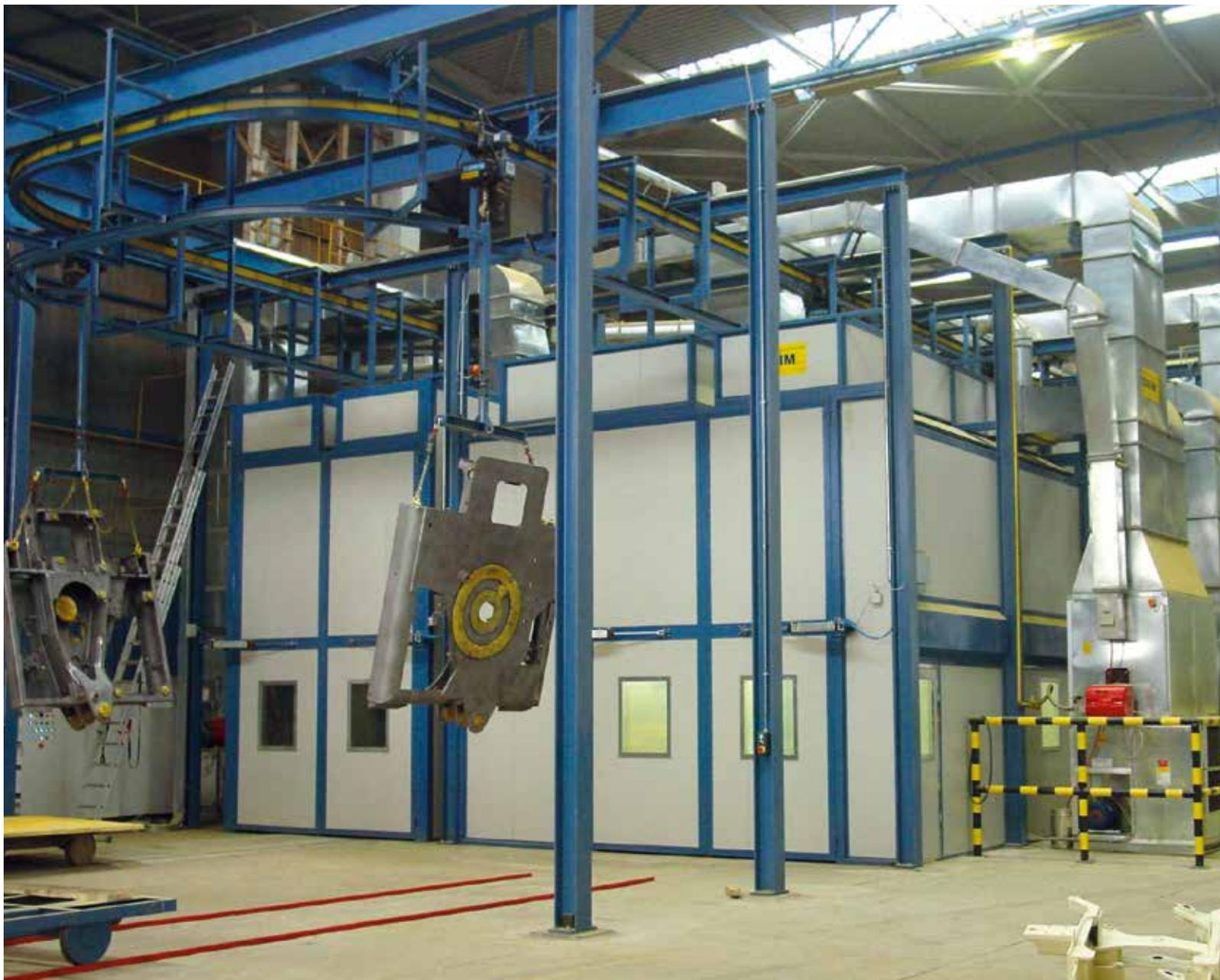
Линия покраски и сушки с подвесным перемещением изделий посредством электрических подъемников управляемых от ПЛК.
