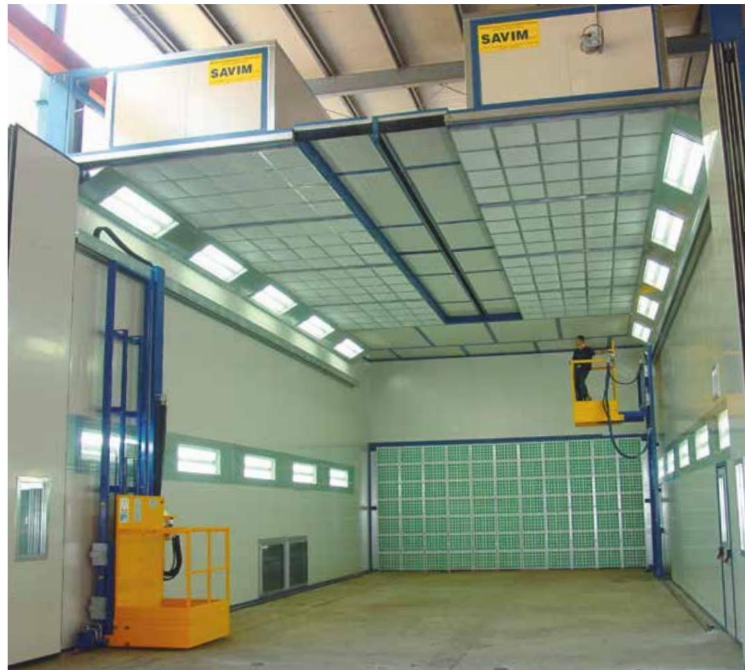
Покрасочно-сушильные камеры с аспирацией от стен и системой сухой фильтрации. Камеры оснащены пневматическими дверями на крыше для прохода крана.
