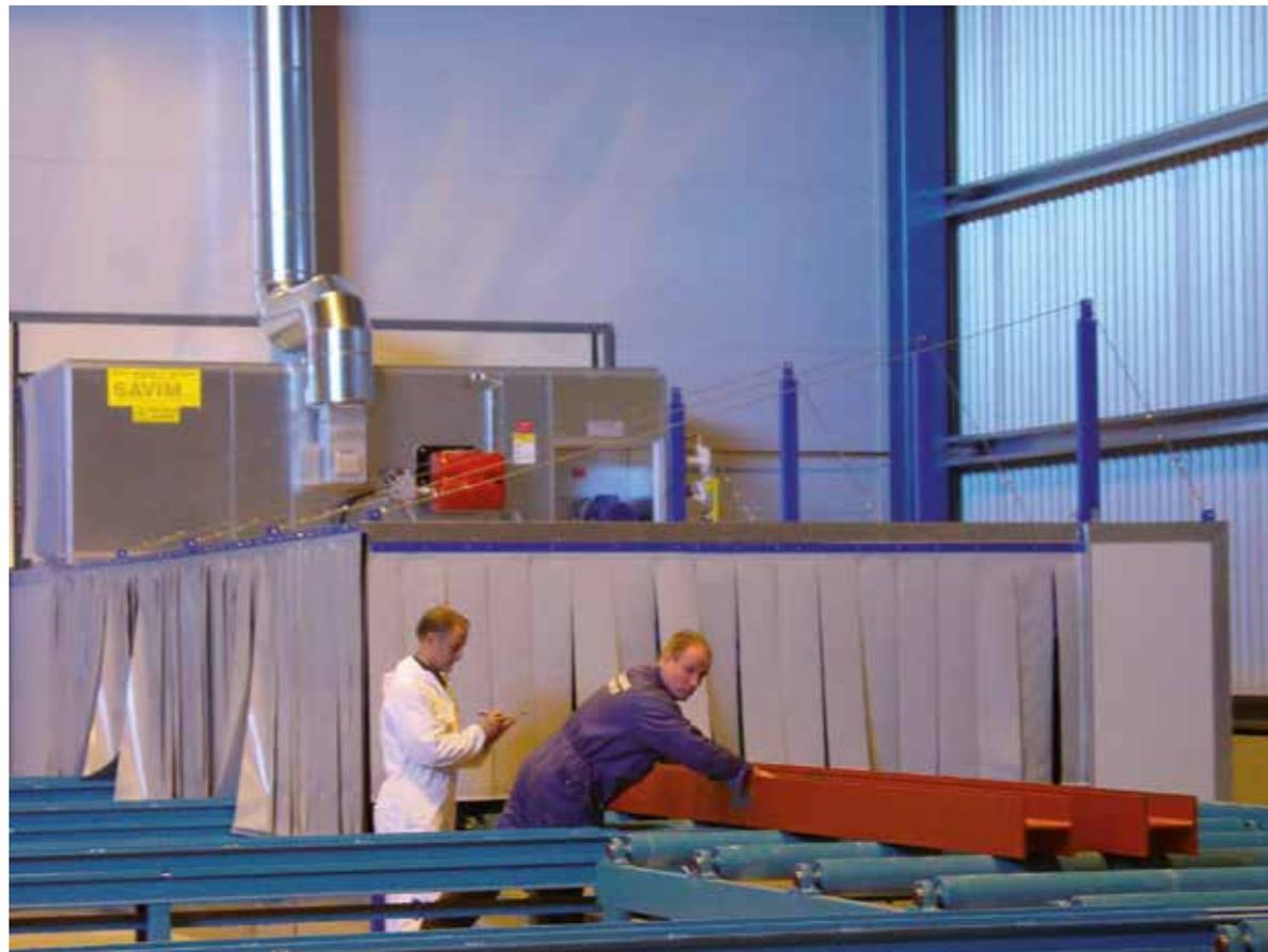
Автоматическая установка покраски как для металлических профилей и листов. Автоматическое цифровое считывание заготовок, контролируемое с ПЛК, позволяет значительно уменьшить отходы краски.
