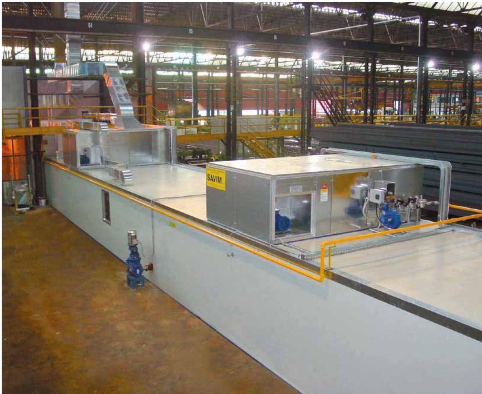
Сушильная камера с размерами согласно типу используемой краски и скорости линии.
