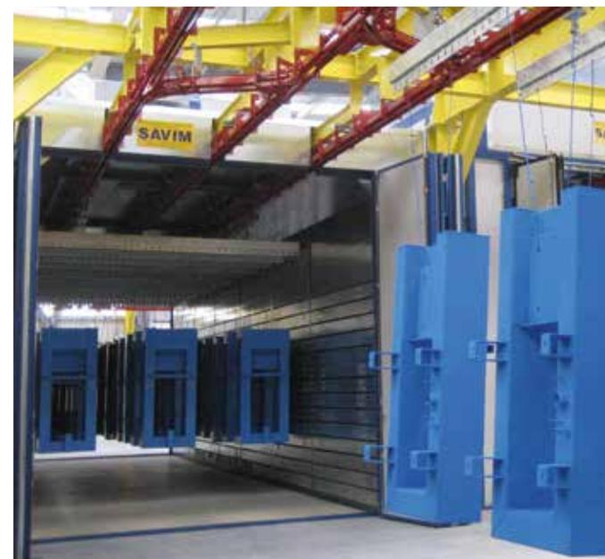
Система порошковой покраски с полуавтоматическим двухрельсовым конвейером в комплекте с вертикальной загрузкой до 2 тонн и полимеризацией горелками прямого обмена с вентиляцией.
