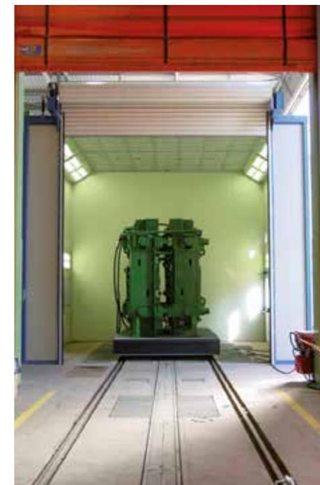
Покрасочно-сушильные камеры с передвижной тележкой грузоподъемностью 40 тонн.
