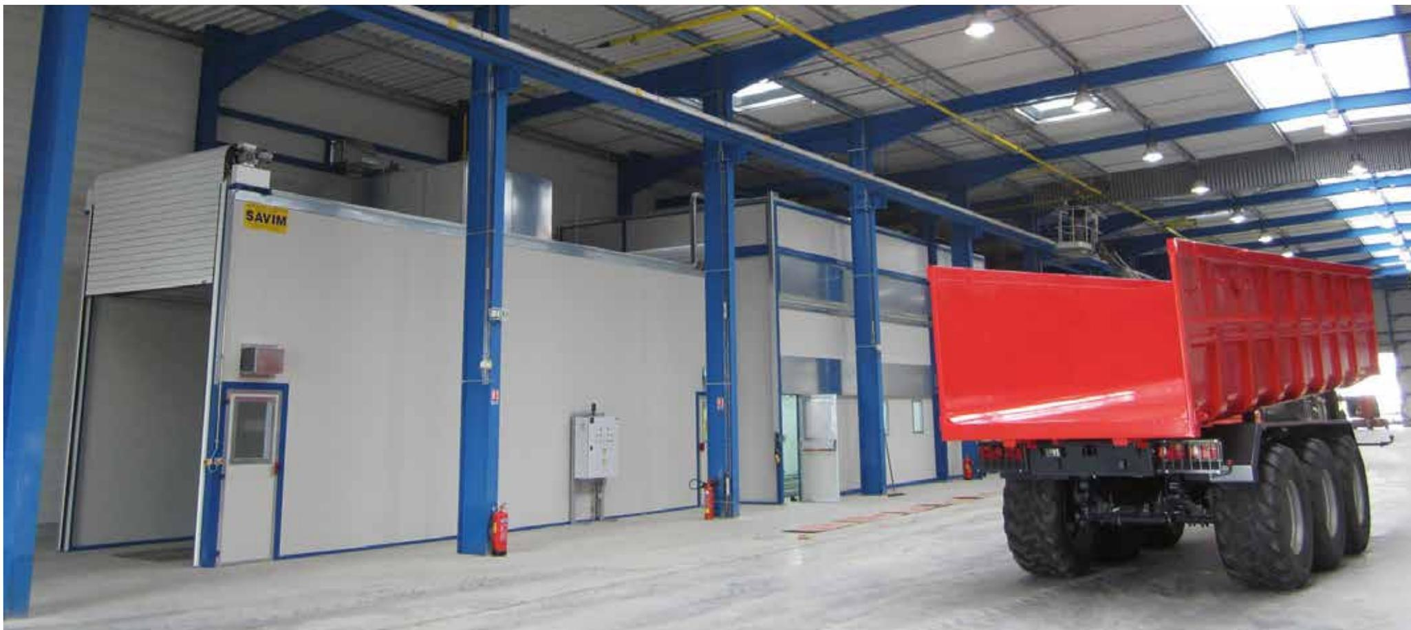
Система жидкой покраски с водорастворимой краской, в комплекте с напольным конвейером. Камеры оборудованы рекуперацией тепла и горелками предварительного смешивания прямого обмена.
