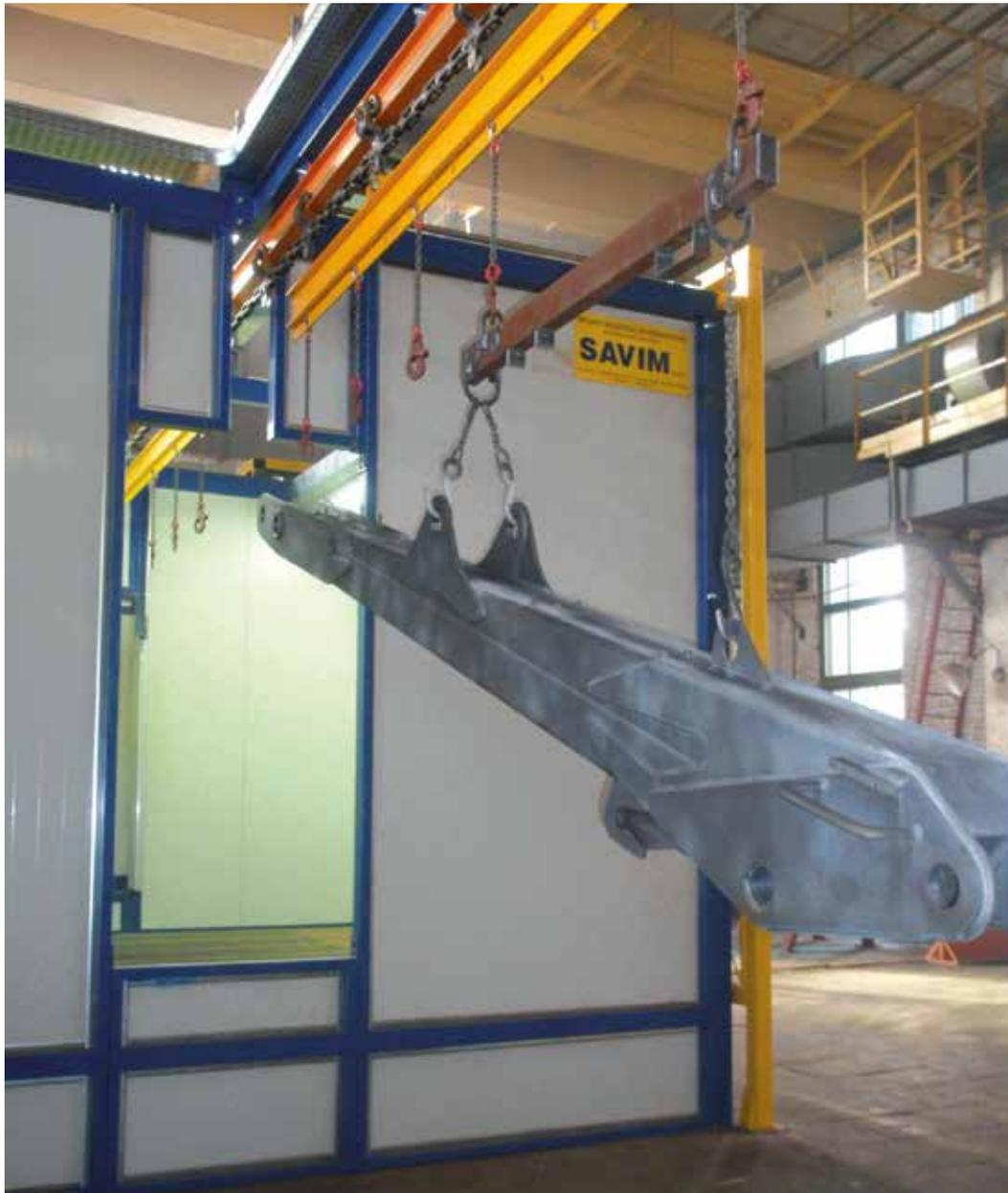
Линия мойки и покраски с подвесным конвейером грузоподъемностью 700 кг.
