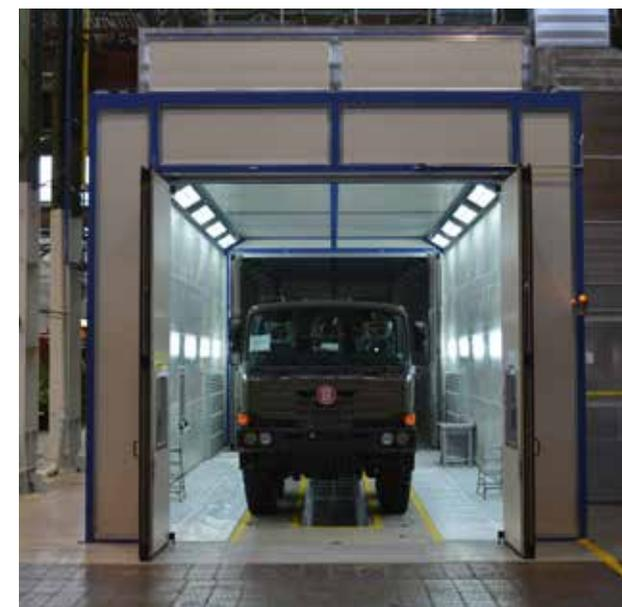
Камера печи покраски для грузовых автомобилей с вытяжкой на противоположных боковых стенках.
