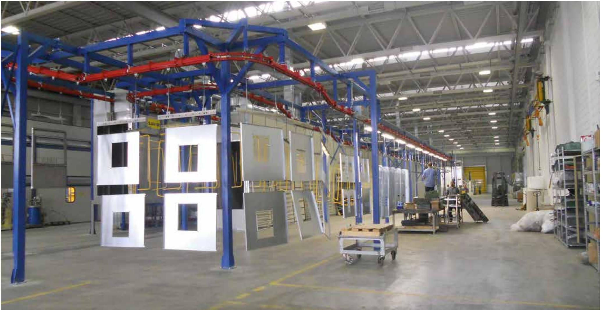
Автоматическая система предварительной обработки с пассивацией через микро-капли и автоматической порошковой покраской.
