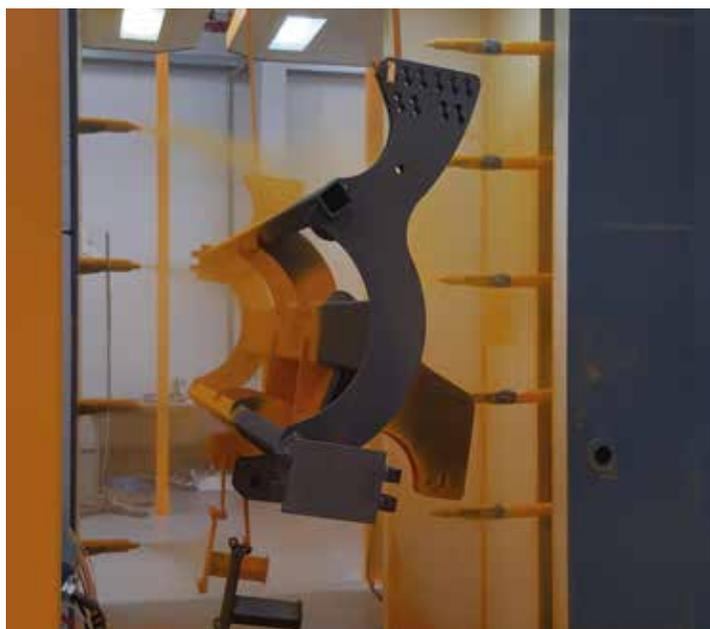
Автоматическая 6-ступенчатая система предварительной обработки и порошковой покраски с двухрельсовым конвейером в комплекте с горелками прямого обмена с вентиляцией.
