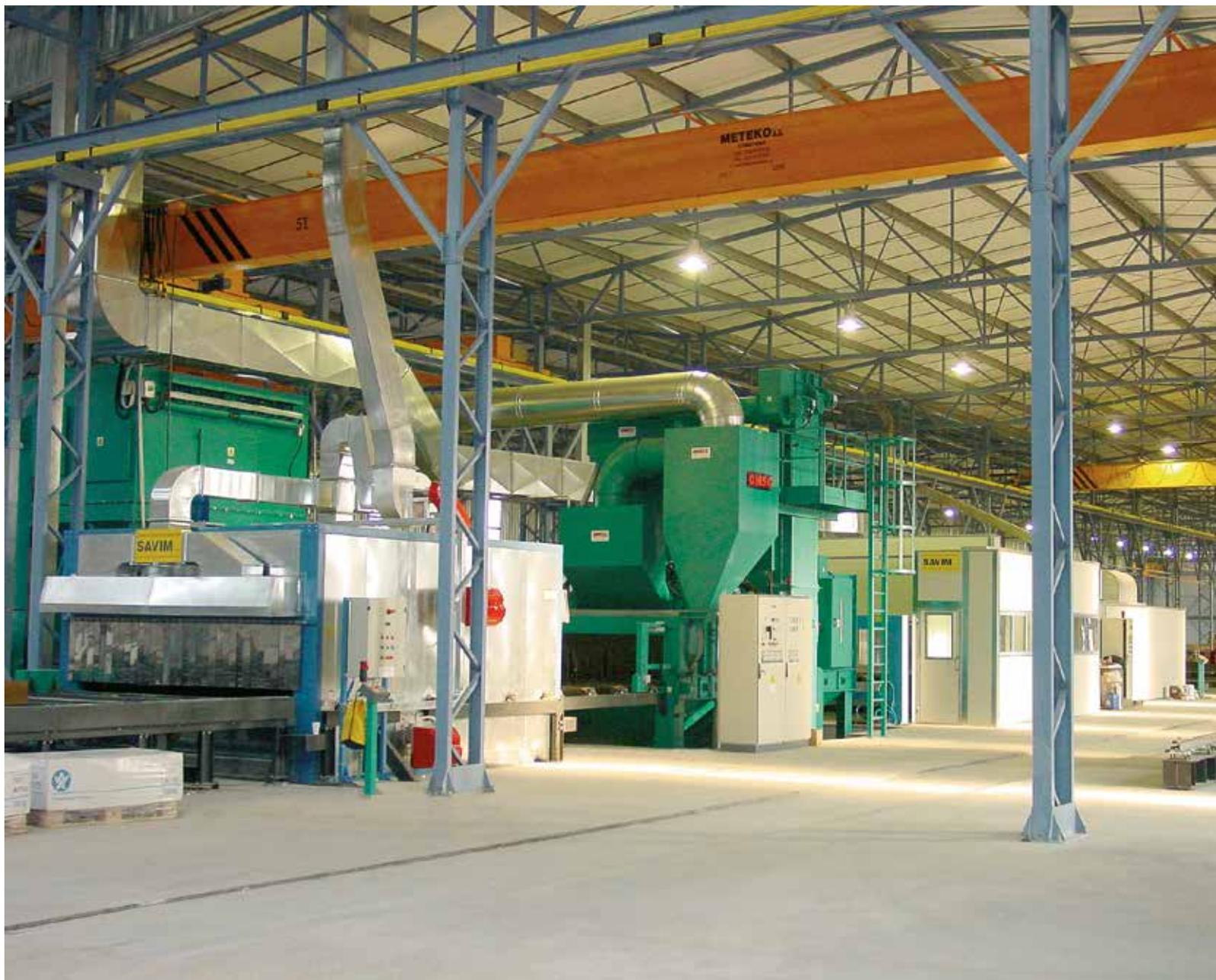
Savim специализируется на производстве автоматических покрасочных линий для листов и профилей, с шириной прохода от 1500 мм до 4000 мм.
