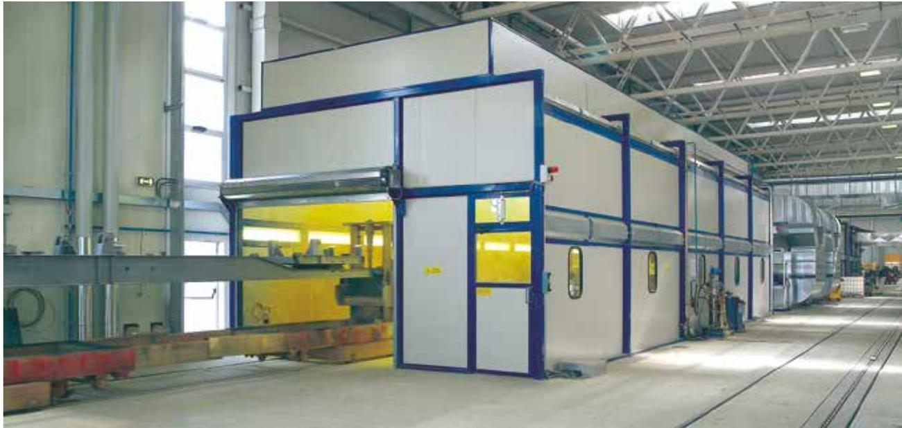
Покрасочная линия с краской на водной основе для шасси грузовиков. Транспортировка изделий обеспечивается поворотными тележками с автоматическим напольным тянущим механизмом.
