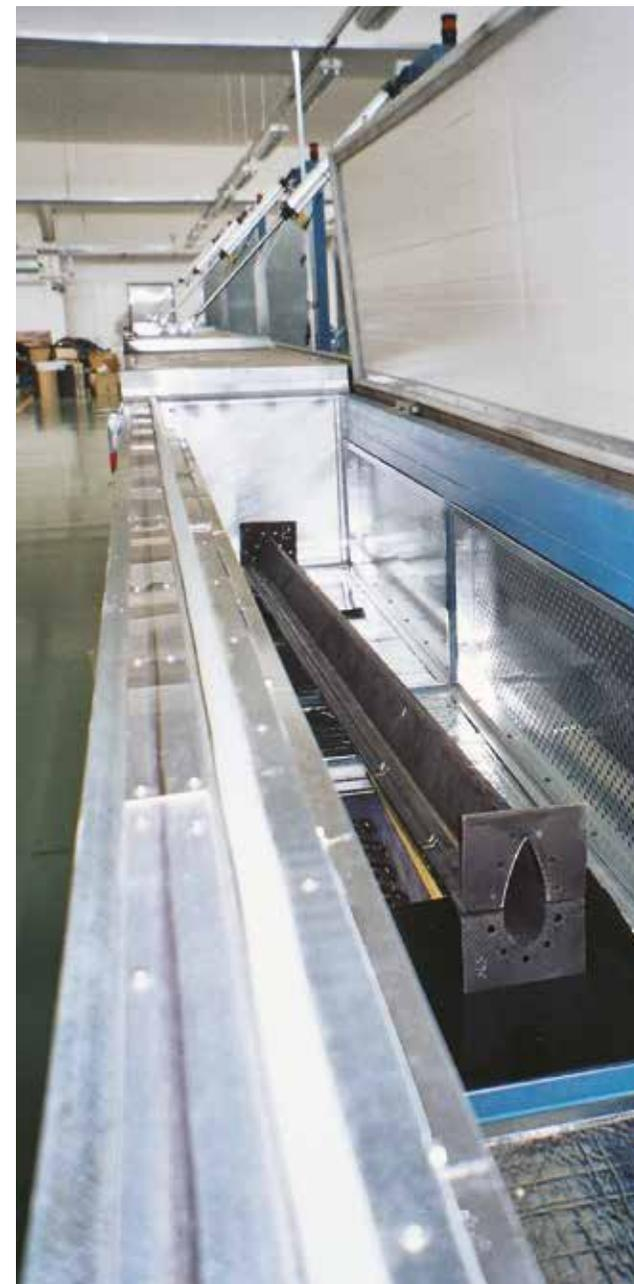
Секционная электрическая печь при 220°C, для рам из углепластика.
