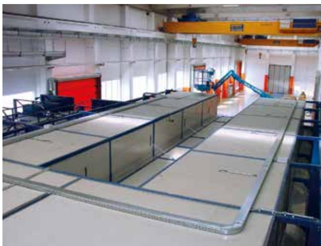
Покрасочно-сушильная камера при 90°C, с размерами 20x10x7 м. и с пневматическим открытием крыши.
