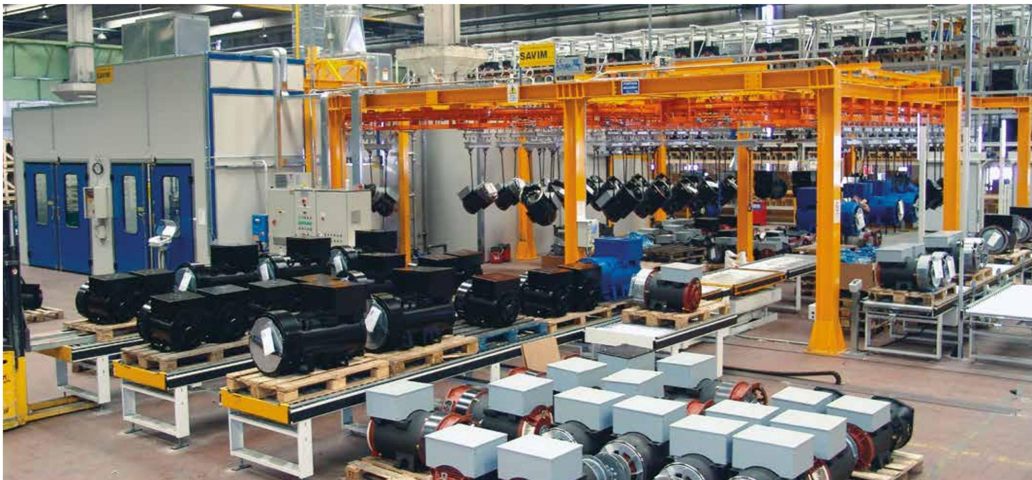
Роботизированная линия жидкостной окраски с краской на водной основе для двигателей и электрических генераторов, с приводным подвесным конвейером и антропоморфным роботом. Линия установлена на Marelli Motori S.p.A, филиал Arzignano (Италия).
