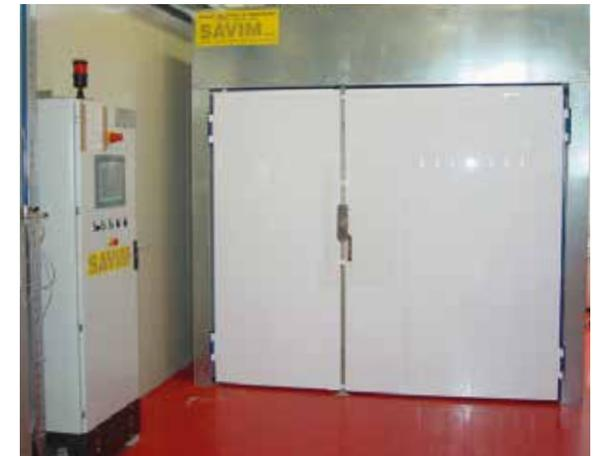
Электрическая печь для полимеризации рам из углепластика, температура контролируется с ПЛК.
