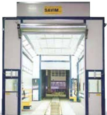
Покрасочная линия для транспортных средств, включает: моечную и сушильную камеры, покрасочную и сушильную камеру для грунта, покрасочную и сушильную камеру для верхнего слоя краски. Камеры оборудованы передвижными, гидравлическими площадками для операторов.
