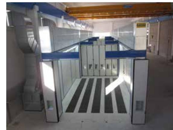
Камера печи с открытым верхом для больших деталей, перемещаемых с помощью крана.
