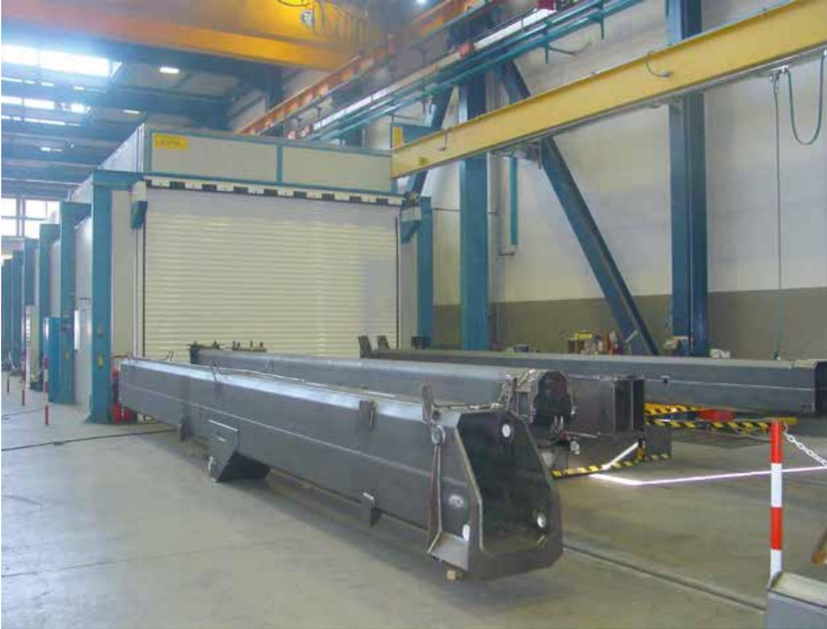
Двойная покрасочно-сушильная камера укомплектованная подвесными тележками для подвеса изделий и тележками для перемещения.
