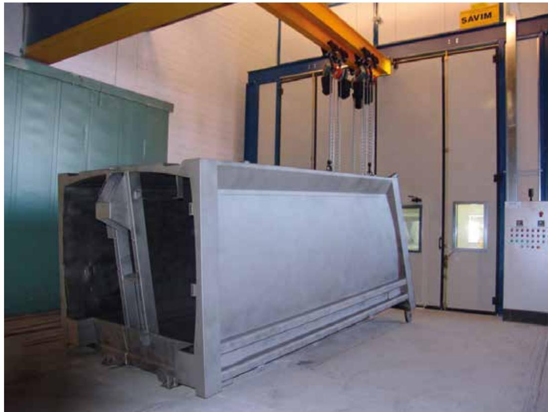
Покрасочная камера с гидравлическими платформами для операторов, и подвесными тележками с подъемными механизмами для транспортировки изделий.
