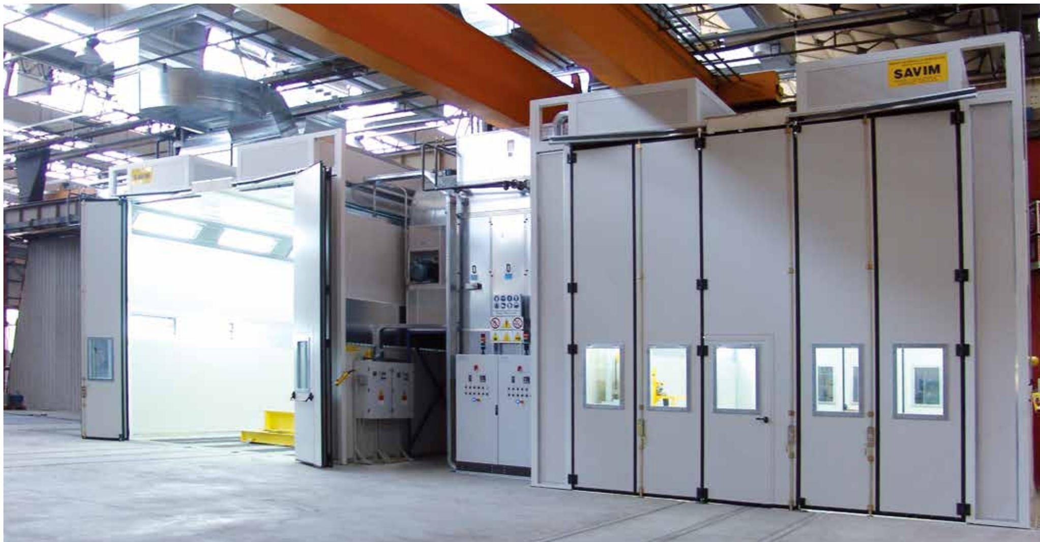
Покрасочно-сушильные камеры с верхними пневматическими дверьми, гидравлическими платформами для операторов и тележками для перемещения изделий.
