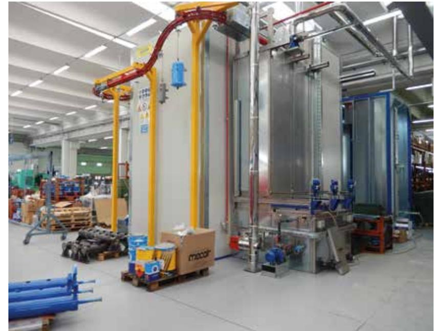
Система автоматической и ручной жидкой и порошковой покраски для резервуаров сжатого воздуха.
