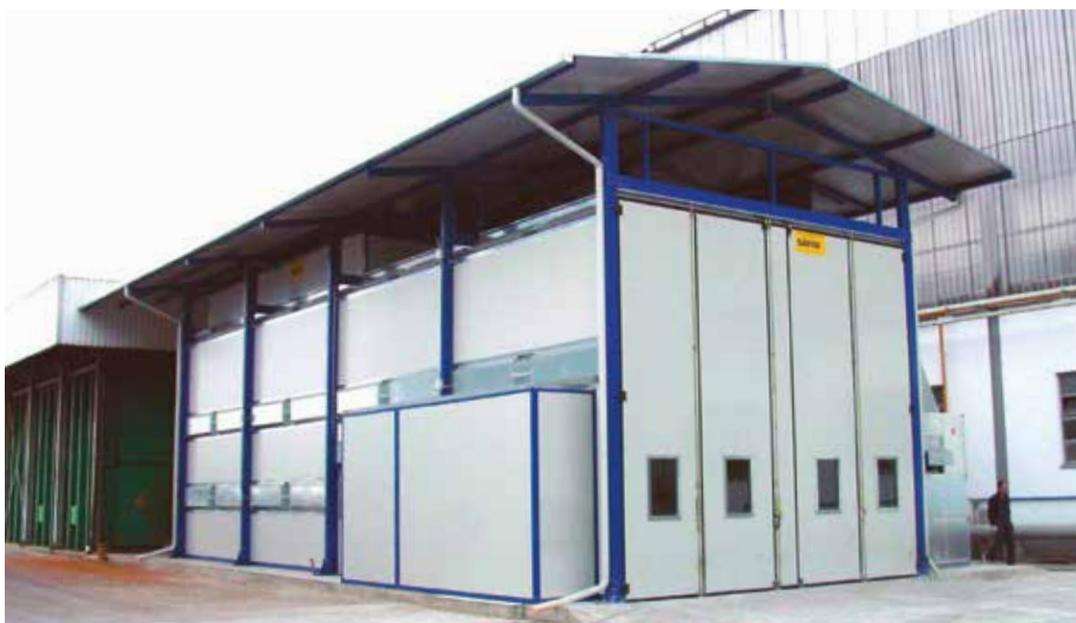
Покрасочно-сушильные камеры 80°C с противоположно расположенными стенами сухой фильтрации и аспирации.
